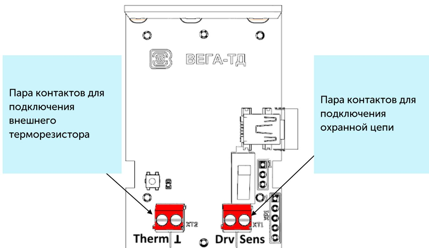
Термодатчик имеет 2 пары контактов. К одной паре (контакты «Therm» и «L») подключается терморезистор, другая пара (контакты «Drv» и «Sens») – охранный вход.
