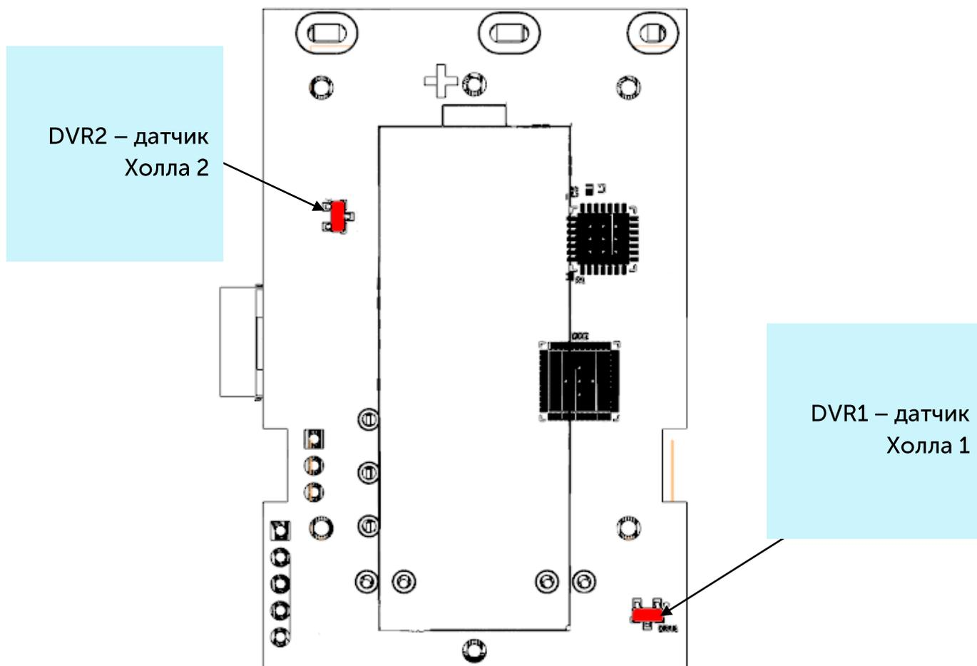
На верхней стороне платы расположен датчик вскрытия корпуса или тампер. При срабатывании тампера в сеть LoRaWAN отправляется пакет с соответствующим сообщением.
