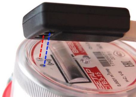
Рисунок 8 — Расположение адаптера «Оптопорт-USB» относительно счетчика\_Крупный план
