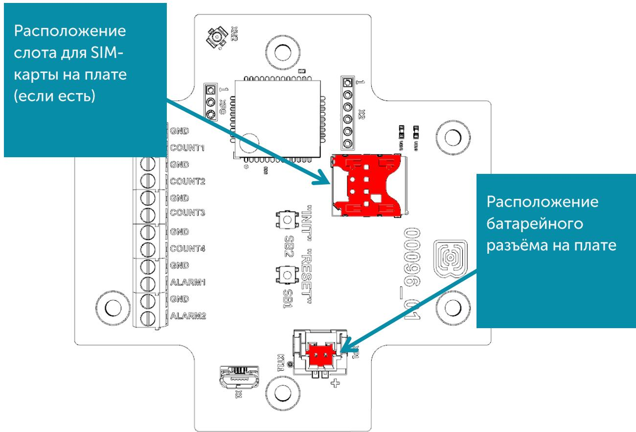
Модем NB-11 работает от встроенной батареи, которая идет в комплекте. После подключения батареи к разъему на плате устройство загружается и уходит в сон до выхода на связь по расписанию.
