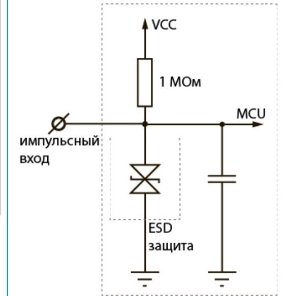
Счетчик импульсов позволяет подключать цепи со следующими типами замыкающих контактов:
