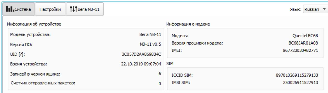
**Информация об устройстве** – конфигуратор считывает информацию о модели устройства, версии его прошивки и автоматически корректирует время устройства при подключении к нему. В этом блоке можно узнать количество записей в черном ящике и количество отправленных устройством пакетов.
