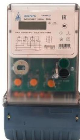
Радиомодем счетчика работает как устройство LoRaWAN класса С.
