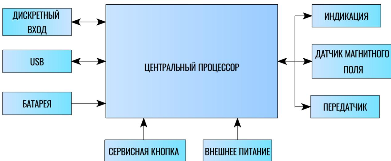
Рисунок 1.2 Структурная блок-схема устройства
